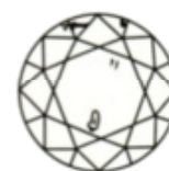
Piqué III Einschlüsse mit bloßem Auge erkennbar
